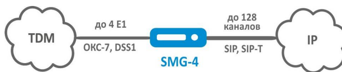
Рисунок 1 – Сопряжение сигнализаций и медиапоточков TDM- и VoIP-сетей с использованием SMG-4
