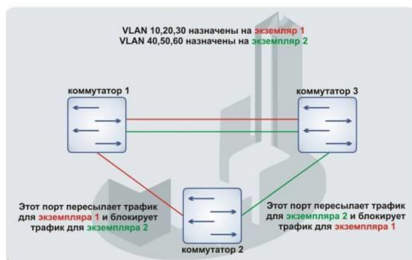
Рисунок А.1 – Настройка протокола множества связующих деревьев
